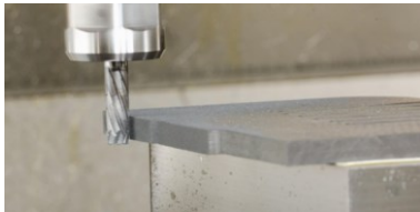
Figure 1 : Détournage de composite CFRP (www.secotools.com)
