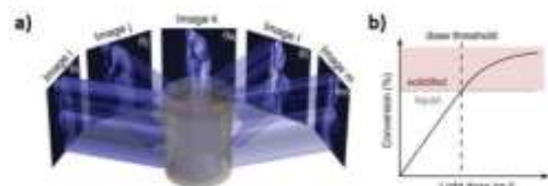
Figure 1: Schéma de principe de l'impression 3D volumétrique[1], technique à utiliser dans le cadre de cette thèse.
